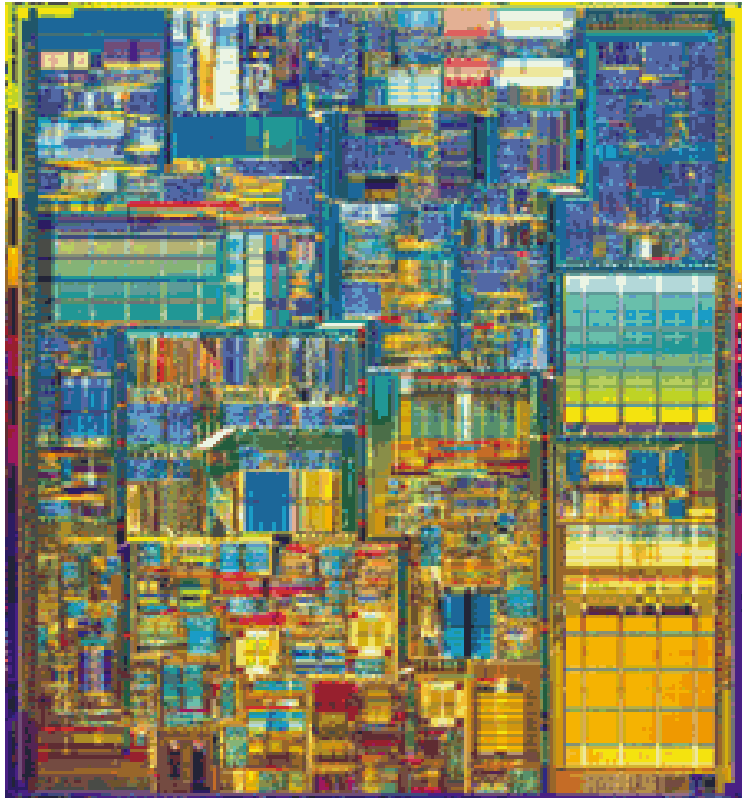
Pentium® 4 42M transistors / 1.3-1.8GHz 49-55W L=180nm
