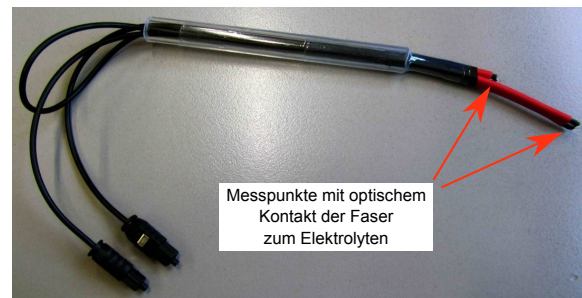
Bild 7. Detailsansicht einer selbstgefertigten optischen Fasersonde. Das Ende der Sonde wird in den Batterieelektrolyten eingetaucht und erlaubt die Bestimmung der ladungszustandsabhängigen Elektrolytdichte über Transmissionsverluste in der Faser. Die Faser ist dazu an zwei Stellen mit entferntem Mantel mit einem sehr starken Biegeradius gekrümmt, so dass eine Wechselwirkung mit dem Elektrolyten dichteabhängige Verluste bewirkt.
