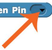
Mit diesem Block können analog angeschlossene Sensoren ausgelesen werden. Die am Pin anliegenden Spannungswerte (0 bis 5 Volt) werden hierbei in 1024 verschiedene Zahlenwerte (0 bis 1023) umgerechnet. Nur die im Bereich „ANALOG IN“ befindlichen Pins A0 bis A5 am Arduino können als analoge Eingänge verwendet werden. Der entsprechende Eingang wird im Auswahlménü gewählt.
