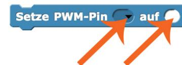
Die digitalen Pins 3, 5, 6, 9, 10 und 11 des Arduino lassen sich per PWM nutzen. PWM steht für Pulsweitenmodulation und bedeutet, dass die digitalen Signale in pseudoanaloge Signale umgewandelt werden. So entsteht die Möglichkeit, 256 verschiedene Werte (0 bis 255) ausgeben zu können, die in der rechten Rundung des Blocks eingegeben werden. Im linken Auswahlfeld wählt man den entsprechenden PWM-Pin.
