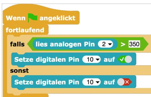
Im Schleifen-Block werden dem digitalen Ausgang 10 in Abhängigkeit von den am analogen Eingang A2 eingelesenen Werten die Werte **wahr** und **falsch** zugewiesen. Ist also der aktuelle Sensorwert an A2 höher als 350, wird die LED angeschaltet. Sonst (also wenn der Sensorwert kleiner oder gleich 350 ist) wird die LED ausgeschaltet.
