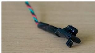
Geschwindigkeit etc.). Je nach Einstellung (Höhe des Widerstandes) wird über S4A ein Wert zwischen 0 und 1023 eingelesen. Dieser kann dann verarbeitet werden. Für diese Zwecke wurde ein Drehpotentiometer an der Eingangsplatine angebracht.
