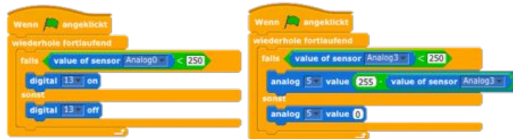
Abbildung 2: S4A-Programme zur Steuerung einer Leuchte anhand der Umgebungshelligkeit (links: digital, rechts: mit PWM)
